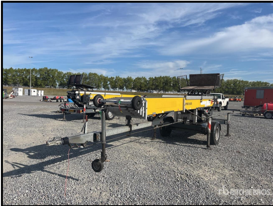
Foto nr.1 – Gjysmë rimorkio lift për bartje të materialeve
